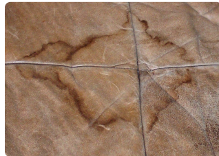
Wasserflecken auf Anilinleder
