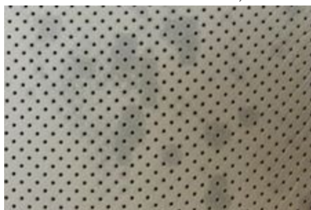
L'humidité a pénétré dans les perforations et taché le cuir.
